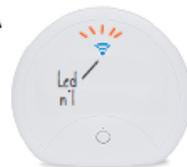
la LED n°1 s'allume après 40s, l'appareil est prêt à être utilisé
